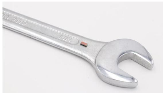
Kyocera RFID-Tag an einem Schraubenschlüssel
