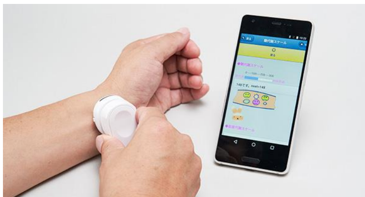
Das Kohlenhydrate-Überwachungssystem zeigt Daten auf dem Smartphone des Nutzers an
